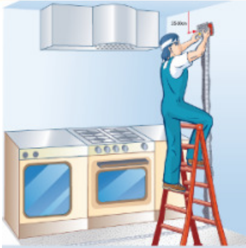
Scatola rivelatore gas CH 4
