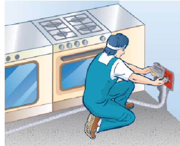
Scatola rivelatore gas GPL
